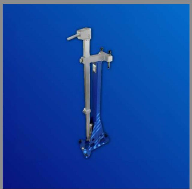
Lo strumento EMTM48 è progettato per misurare l'allineamento dei rulli ai piedi della lingottiera e dell'allineamento dei rulli sui segmenti dell'impianto CCM. Misura l'angolo tra il piano di allineamento dei rulli e l'asse di gravità. La misura è espressa in gradi, ed è indicata su un display digitale, posto nella parte superiore dello strumento.
